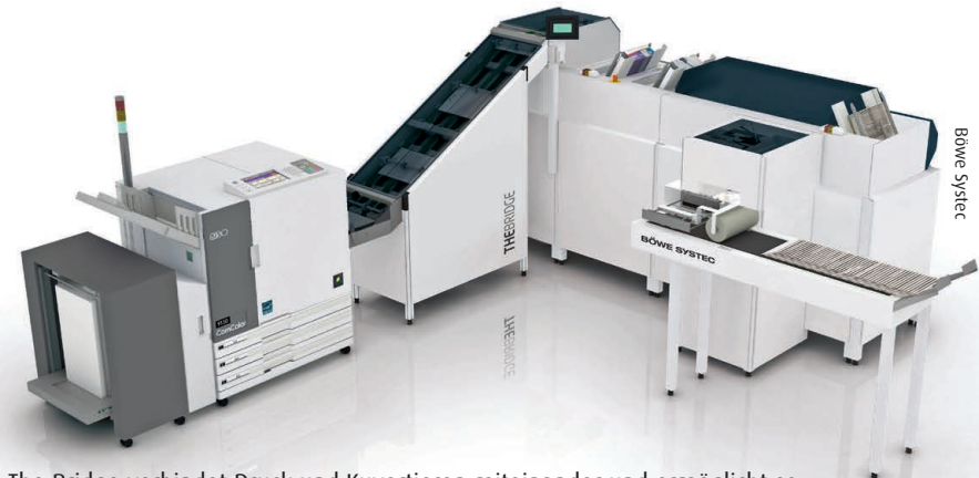
The Bridge verbindet Druck und Kuvertieren miteinander und ermöglicht so die White Paper Factory in Mailroom- und Office-Umgebung.
